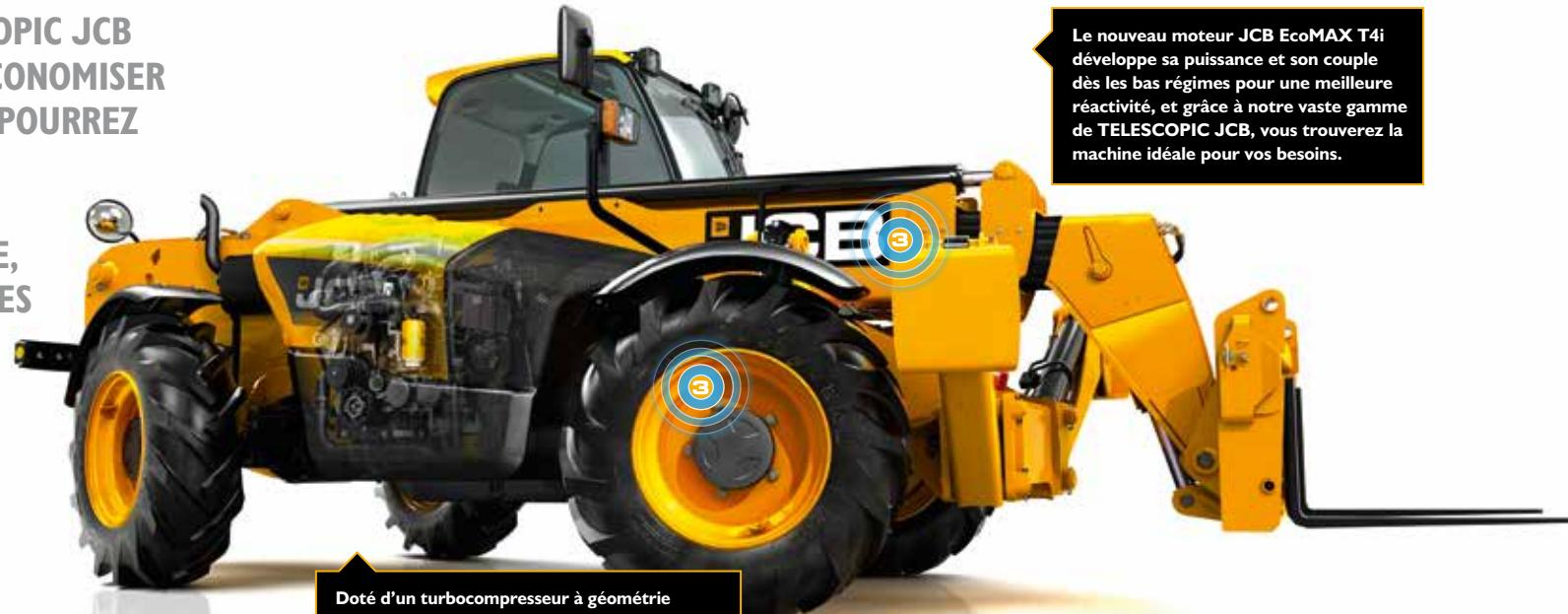
Doté d'un turbocompresseur à géométrie variable conférant d'excellentes performances même à bas régime, le moteur JCB EcoMAX T4i fournit un excellent rendement énergétique.
