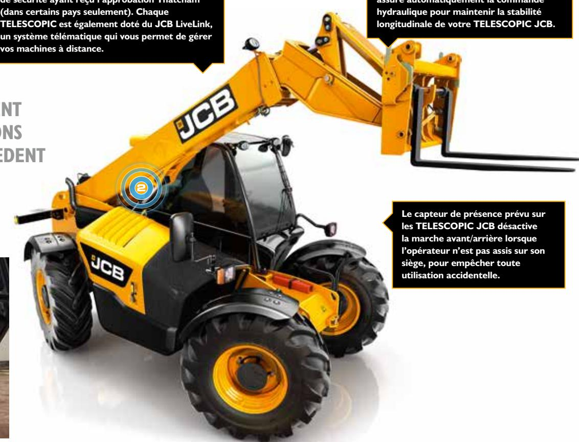
Le contrôleur de charge adaptatif ALC JCB assure automatiquement la commande hydraulique pour maintenir la stabilité longitudinale de votre TELESCOPIC JCB.
