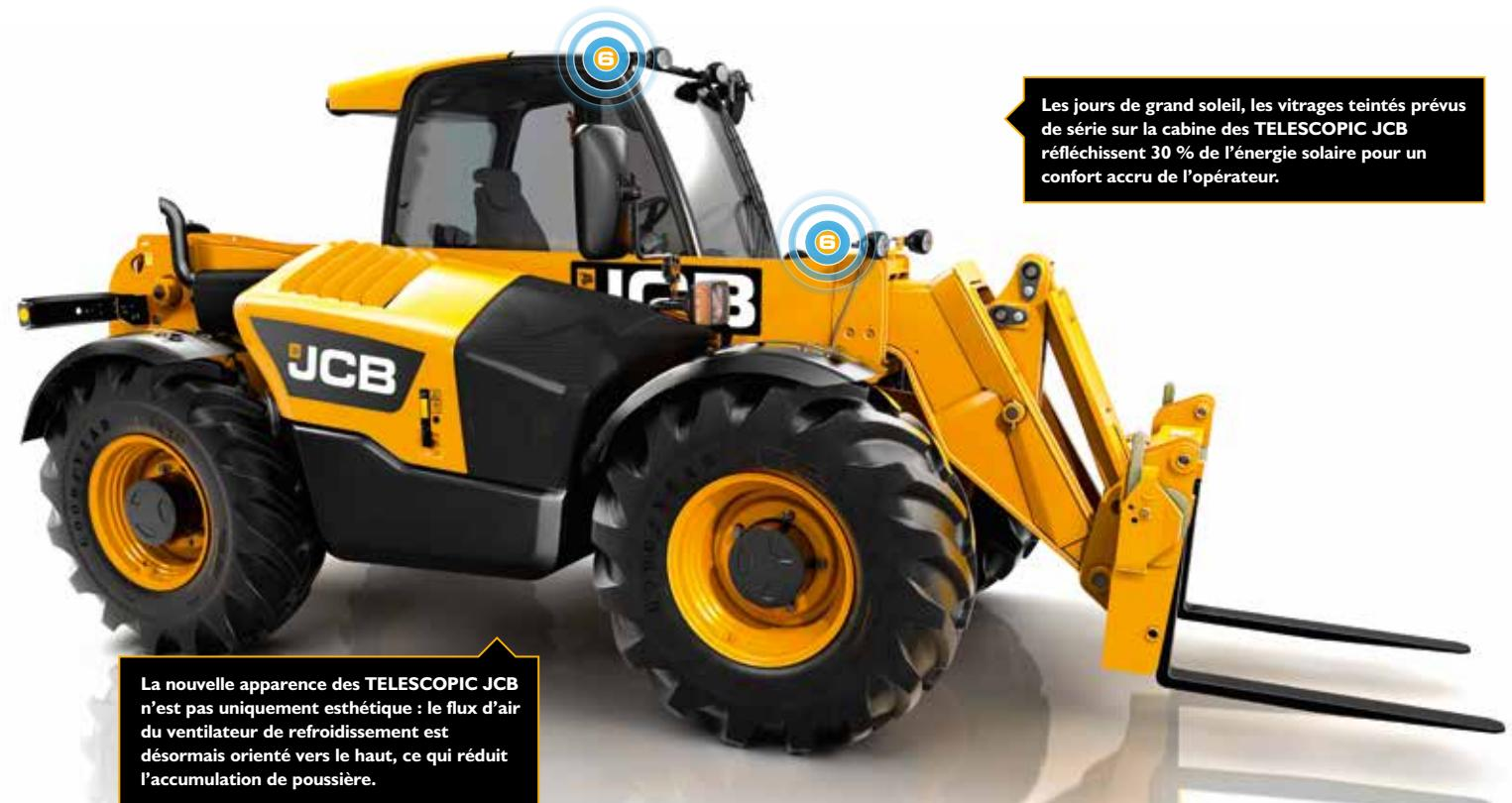
La nouvelle apparence des TELESCOPIC JCB n'est pas uniquement esthétique : le flux d'air du ventilateur de refroidissement est désormais orienté vers le haut, ce qui réduit l'accumulation de poussière.
