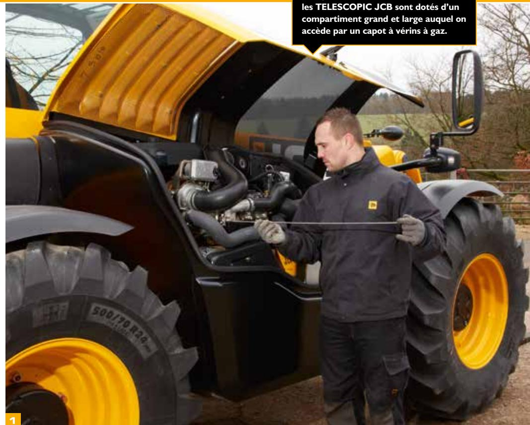
Pour permettre des inspections simples et rapides sur les trois côtés du moteur, les TELESCOPIC JCB sont dotés d'un compartiment grand et large auquel on accède par un capot à vérins à gaz.
